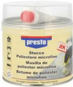
Hochelastischer, zweikomponentiger Polyester-Feinspachtel zum Ausfüllen kleinerer Unebenheiten und zum dünnen „Feinspachteln“ schon vorbehandelter Flächen. Geeignet für Untergründe aus Metall, Holz, Beton oder auf mit presto Füllspachtel vorgespachtelte Untergründe. Durch mikrofeine Füllstoffe erhält man eine sehr glatte Oberfläche.
