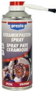
Metallfreie Hochtemperaturpaste mit hervorragender Schmierwirkung. Guter Korrosionsschutz. Ideal geeignet für Montagearbeiten an ABS-Bremsanlagen sowie zur Langzeitschmierung von hochbelasteten Gleitflächen aller Art. Temperaturbeständig von -40°C bis +1.400°C. Der abnehmbare Pinselkopf ermöglicht ein einfaches und gleichmäßiges Aufbringen der Paste.
