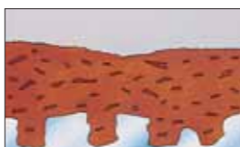
Mit BOB Grundierung fertig zum Lackieren.
