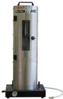
Le Macchine riempitrici ColorMatic VitoMat sono utilizzate per consentire un riempimento facile e veloce delle bombole pre-caricate Colormatic con vernice del colore desiderato (già pre-caricate con propellente e solvente). Le Macchine riempitrici VitoMat sono disponibili in 3 diverse versioni per soddisfare le molteplici necessità individuali. Tutte le VitoMat sono adatte a bombole da 400 ml e 150 ml.
