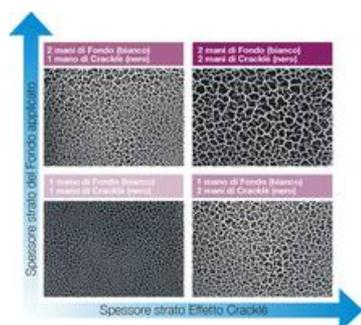
Non appena si applica l'effetto spray sopra la verniciatura precedente, inizia sulla superficie il processo di "screpolatura".
